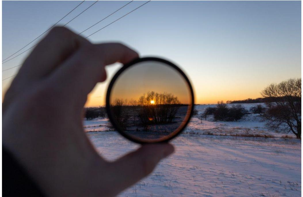
Le nombre indique le coefficient de multiplication du temps de pose à prendre en compte pour régler l'exposition. Un filtre ND1000 demande un temps de pose 1000 fois supérieur à celui qu'il faudrait adopter sans filtre. Le boîtier propose un temps de pose d'1/1000 ème de seconde sans filtre ? Avec un ND1000 vous passerez à 1 seconde.
